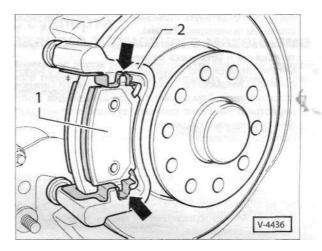
Вынуть тормозные колодки -1- вместе с удерживающими пружинами -стрелки- из направляющей тормозных колодок -2-.
