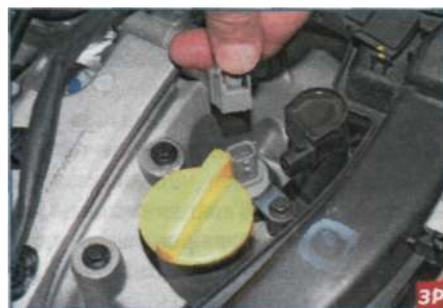
Нажав на фиксатор колодки проводов, отсоединяем колодку от разъема клапана.
