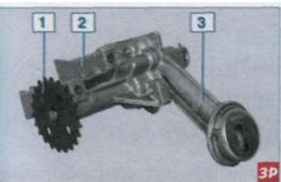
1 - ведомый шкив привода; 2 - корпус насоса; 3 - корпус насоса с маслоприемником
