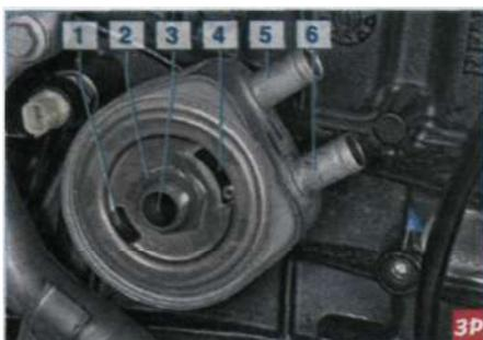
Элементы теплообменника (показано при снятом масляном фильтре): 1 - канал подвода масла к фильтру; 2 - штуцер крепления масляного фильтра и теплообменника к блоку цилиндра; 3 - канал отвода масла из фильтра; 4 - канал с обратным клапаном подвода масла к фильтру; 5 - патрубок подвода охлаждающей жидкости к теплообменнику; 6 - патрубок отвода охлаждающей жидкости из теплообменника
