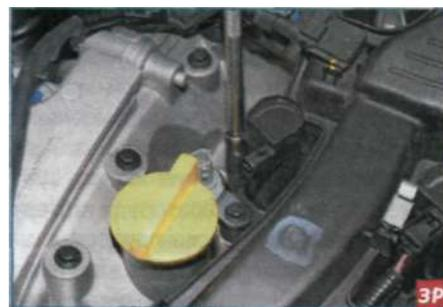
Головкой «на 8» с удлинителем отворачиваем болт крепления кронштейна
