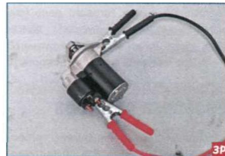
...соединяем проводами «плюсовой» вывод аккумуляторной батареи с нижним контактным болтом тягового реле, а «минусовой» вывод - с корпусом стартера.
