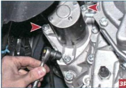
Головкой «на 13» отворачиваем три гайки крепления стартера.
