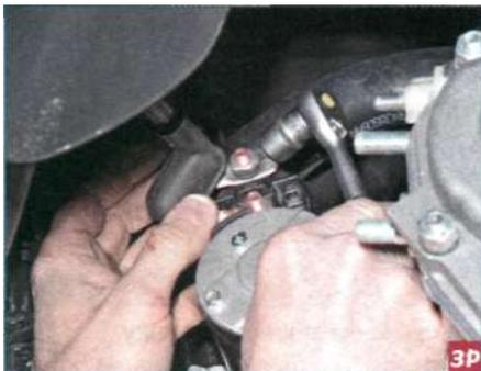
Сдвинув защитный колпачок, головкой «на 13» отворачиваем гайку...
