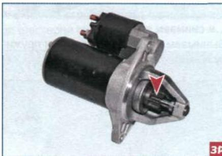
...отверткой проворачиваем шестерню привода.
