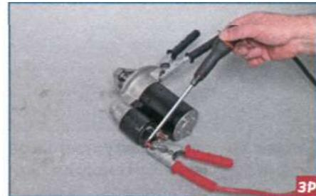
Отверткой перемыкаем верхний контактный болт и управляющий вывод тягового реле.
