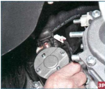
Отсоединяем колодку провода управления от вывода тягового реле.
