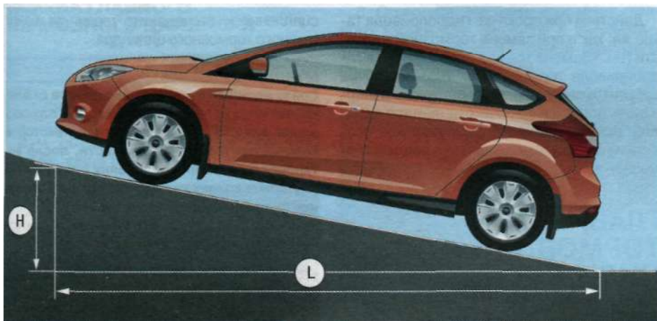
Рис. 9.3. Проверка стояночного тормоза
