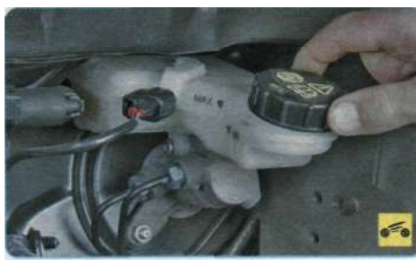
1. Снимите пробку с горловины бачка главного тормозного цилиндра.
