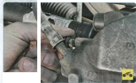
4. Очистите от грязи клапаны выпуска воздуха передних и задних колес. Снимите защитные колпачки с клапанов выпуска воздуха тормозных механизмов передних...
