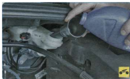
2. Откачайте старую тормозную жидкость из бачка главного тормозного цилиндра.
