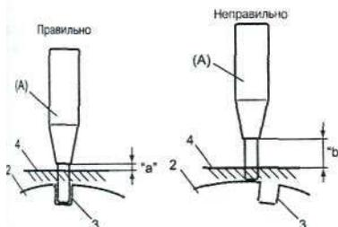
**22.61 Выравнивание балансировочного вала №1 перед установкой насосной сборки (двигатель J24B)**
