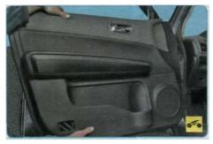
2. Снимите обивку передней двери (см. «Снятие и установка обивки передней двери», с. 265).
