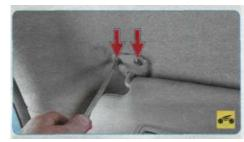
Выверните два винта крепления...
