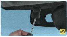
1. Подденьте отверткой и отожмите фиксатор крепления зеркала.
