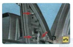
5. Отверните три гайки крепления...
