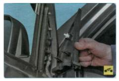
4. Подденьте отверткой, потяните на сея и снимите облицовку зеркала.
