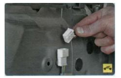
3. Отожмите фиксатор колодки и отсоедините колодку жгута проводов от наружного зеркала.
