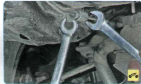
9. Отверните гайку переднего конца трубки из соединительной муфты, удерживая муфту вторым ключом.
