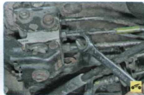
10. Отверните гайку крепления заднего конца трубки к регулятору тормозных сил в гидроприводе задних тормозов...
