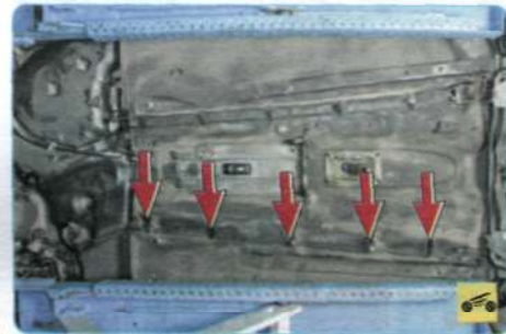
Так расположены держатели трубопроводов на днище кузова.
