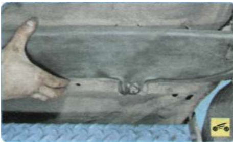
4. Ослабьте затяжку болта бокового крепления щитка, сдвиньте щиток вбок настолько...
