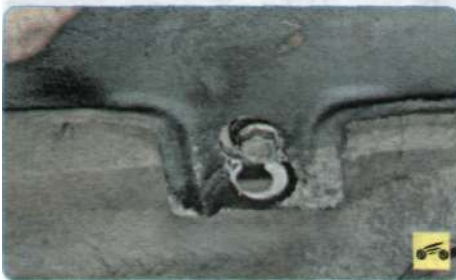
5. ...чтобы головка болта совпала с увеличенной частью отверстия...
