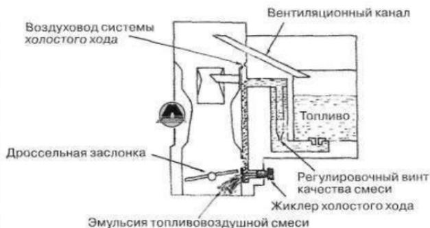
*Система холостого хода обеспечивает подачу топливоздушной смеси на низких оборотах и холостом ходу. В большинстве карбюраторов при повороте регулировочного винта можно обеднить или обогатить топливоздушную смесь.*
