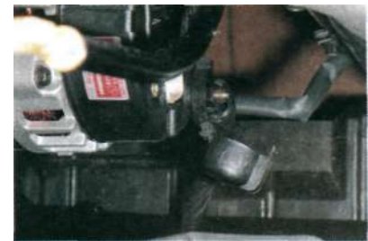
...открываем защитный колпачок вывода «В+» генератора.
