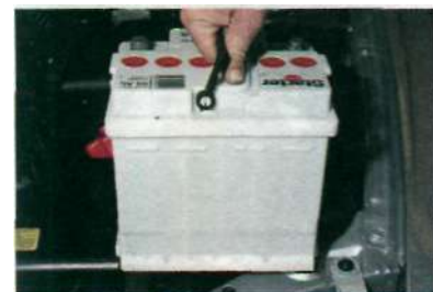
Вынимаем аккумуляторную батарею из моторного отсека.
