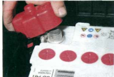
Приподняв защитную крышку... ...аналогично снимаем клемму «плюсового» провода.
