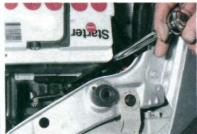
Головкой «на 12» с удлинителем отворачиваем болт...
