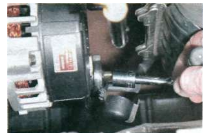
Головкой «на 12» отворачиваем гайку крепления провода...
