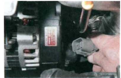
...отсоединяем колодку проводов.
