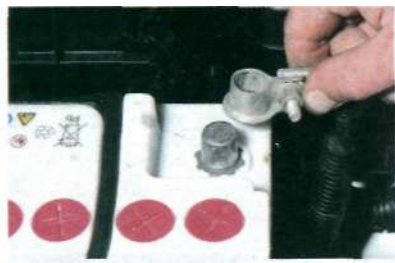
...и снимаем клемму.
