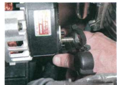
...и снимаем его с вывода «В+» генератора.
