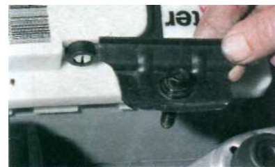
...и снимаем прижимную скобу.
