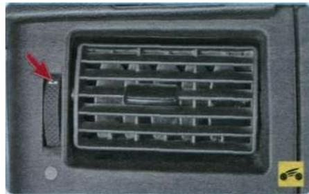
В крайнем верхнем положении рукоятки поток воздуха максимален...
