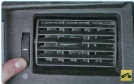
Поворотом регулятора изменяют интенсивность потока воздуха.
