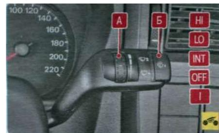
**8 - рычаг переключателя очистителя и омывателя ветрового стекла и стекол задних дверей.** Рычагом включают электрические цепи при включенном зажигании.
