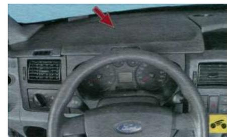
**7, 1 4 - вещевые отсеки в панели приборов.**
