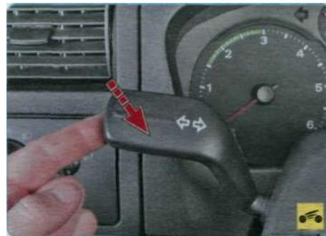
Для сигнализации нажмите на рычаг переключателя по направлению к рулевому колесу до первого нефиксированного положения. При этом в комбинации приборов загорится сигнализатор 11 (см. рис. 1.7) включения дальнего света фар;
