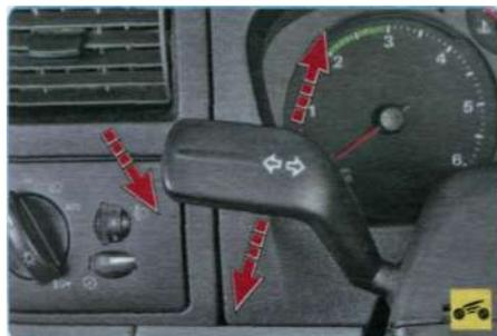
**4 - рычаг переключателя наружного освещения и указателей поворота** (левой подрулевой переключатель) работает в следующих режимах:
