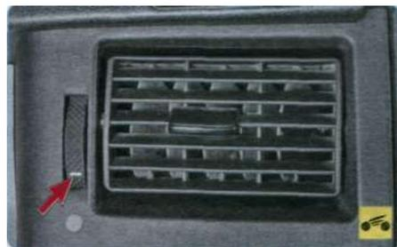
...а в крайнем нижнем - поток воздуха перекрыт.
