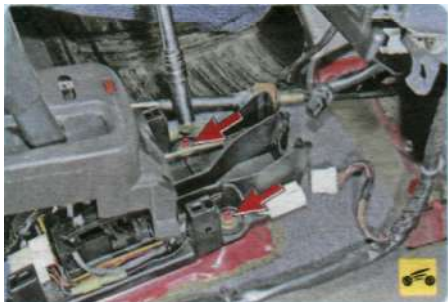
20. Отверните две гайки переднего крепления кулисы селектора к основанию кузова. 21. Установите автомобиль на подъемник или смотровую канаву.
