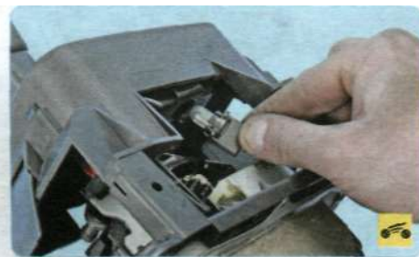
28. При необходимости извлеките патрон лампы подсветки шкалы из корпуса шкалы...
