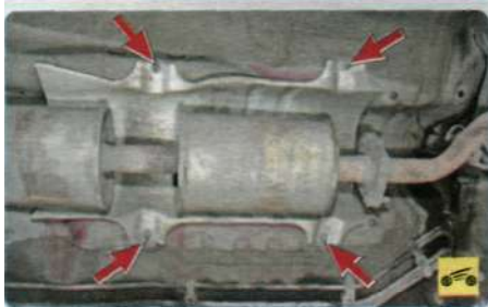
Так расположены гайки крепления термоэкрана дополнительного глушителя.
