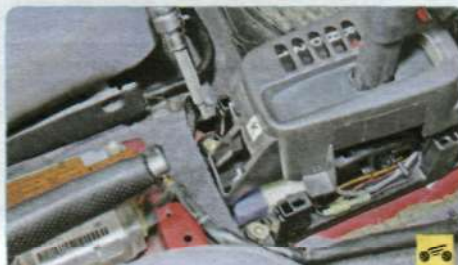
24. Отверните две гайки заднего крепления кулисы селектора к основанию кузова.
