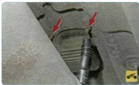
24. Отверните две гайки заднего крепления кулисы селектора к основанию кузова.
