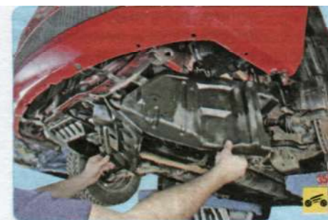
3. Снимите левый брызговик двигателя (см. «Снятие и установка брызговиков двигателя», с. 69).
