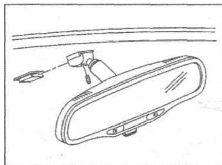
3. Сдвиньте зеркало и снимите его.
