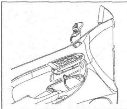
2. Снимите переключатель с отделочной панели передней двери.
