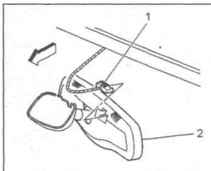
2. Ослабьте винт крепления основания зеркала.
