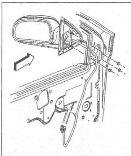
5. Отсоедините фиксатор крепления зеркала к двери.
