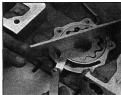
75.9. При помощи поверочной линейки и плоских щупов проверьте зазор между поверхностью крышки масляного насоса и роторами.
