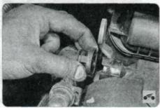
2. ...и отсоедините наконечник от патрубка крышки головки блока цилиндров.
