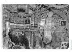
15. Выверните две шпильки А и два болта Б крепления задней опоры подвески силового агрегата к картеру крышки опор кораных подшипников коленчатого вала...
