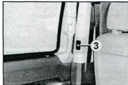
**ОУ-059** Кнопка управления электроприводом сдвижной двери в проёме двери (стойка В)
