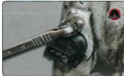
...и извлечь датчик скорости из корпуса коробки передач.
