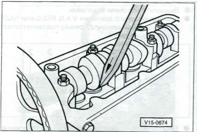
**Внимание!** После установки нового гидравлического толкателя двигатель нельзя запускать в течение примерно 30 минут, иначе клапан может сесть на поршень, что приведет к повреждению поршня и (или) клапана.
