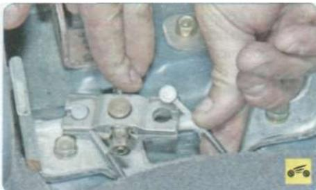
5. ...отсоедините наконечник заднего троса привода стояночного тормоза от уравнителя.
