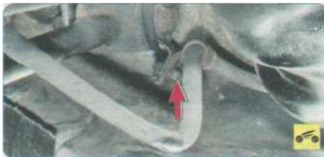
7. ...и к кронштейну крепления продольного рычага задней подвески.
