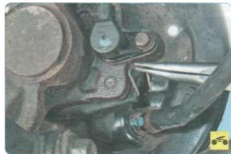
12. ...и снимите пружинный фиксатор заднего троса привода стояночного тормоза.
