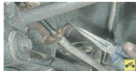
14. На автомобиле с дисковыми тормозными механизмами задних колес захватите пассатижами отогнутый край пружинной скобы крепления оболочки троса привода стояночного тормоза снимите скобу.
