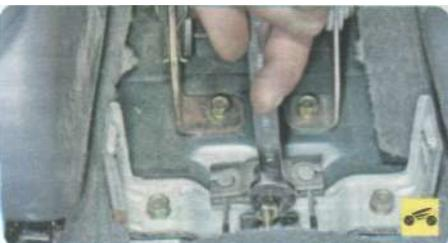
3. Полностью ослабьте натяжение тросов, отвернув регулировочную гайку до самого конца наконечника троса рычага привода стояночного тормоза.
