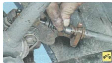
15. Снимите с наконечника оболочки защитный чехол и сдвиньте его назад по тросу...
