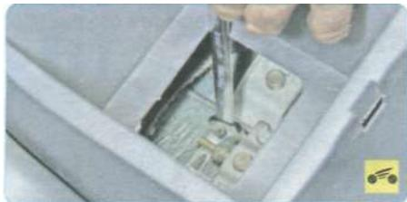
7. Заверните регулировочную гайку на тросе рычага привода стояночного тормоза до момента полного затормаживания задних колес.
