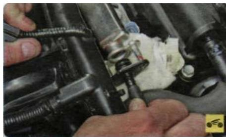
5. Отсоедините от топливной рампы магистраль подачи топлива (см. «Снятие и установка топливной рампы», с. 116).
