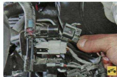
10. ...и разъедините колодку управляющего датчика концентрации кислорода.
