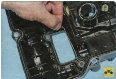
22. ...и прокладку корпуса электромагнитного клапана системы изменения фаз газораспределения.
