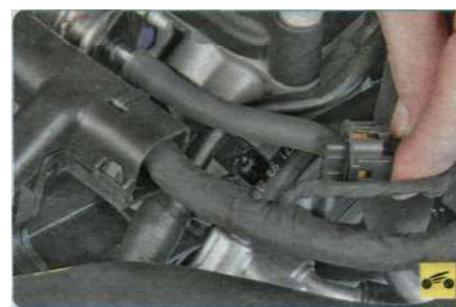
8. Аналогично отсоедините колодку жгута проводов от датчика положения распределительного вала.
