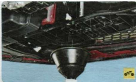
4. Слейте жидкость из системы охлаждения двигателя (см. «Замена охлаждающей жидкости», с. 83).
