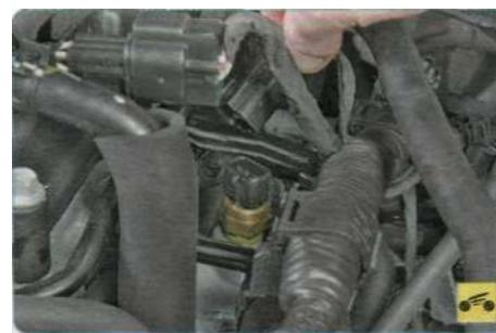
7. Сжав фиксатор, отсоедините колодку жгута проводов от датчика температуры охлаждающей жидкости.
