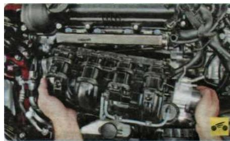
6. Снимите впускную трубу в сборе с дроссельным узлом (см. «Замена прокладки впускной трубы», с. 83).
