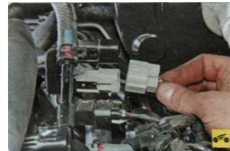
11. Аналогично разъедините колодку диагностического датчика концентрации кислорода.
