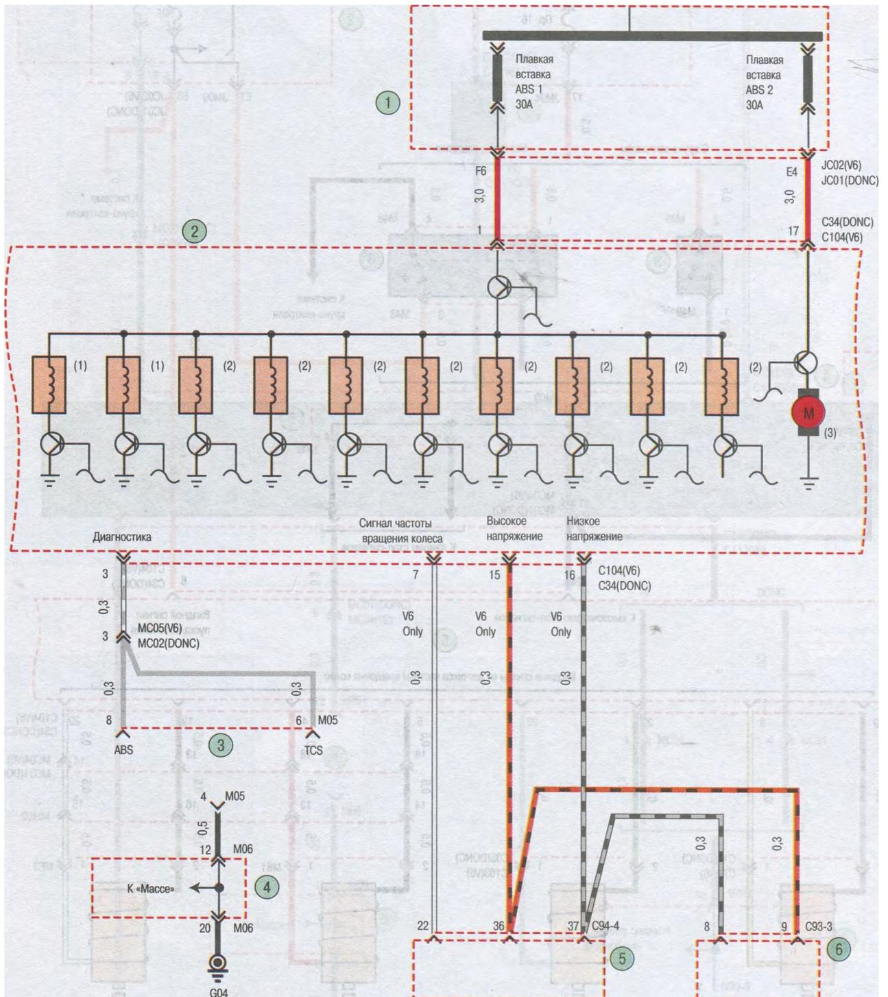
Схема 36. Антиблокировочная система тормозов: 1 - монтажный блок в моторном отсеке; 2 - гидроэлектронный модуль ABS: соленоид TCS (1), соленоид ABS (2), двигатель насоса ABS (3); 3 - диагностический разъем; 4 - соединительный разъем; 5 - электронный блок управления двигателем ECU; 6 - блок управления коробкой передач (TCM)
