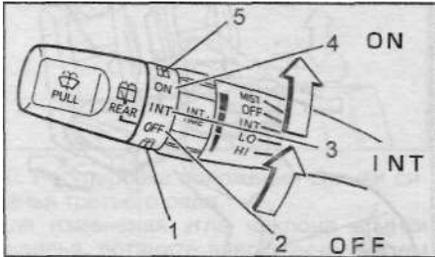
4. Для включения омывателя при работе стеклоочистителя на низкой скорости поверните ручку переключателя вверх из положения "ON".
