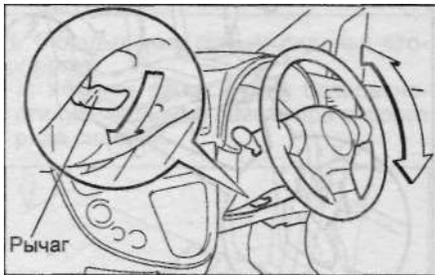
Дальнейшая регулировка производится перемещением рулевого колеса по вертикали, при этом рулевое колесо стремится занять самое верхнее положение, так как оно подпружинено. Для фиксации выбранного положения необходимо вернуть рычаг блокировки в исходное положение.
