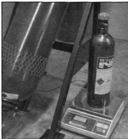
Взвешивание баллона до и после заправки закиси, эта процедура важна для точного контроля.
