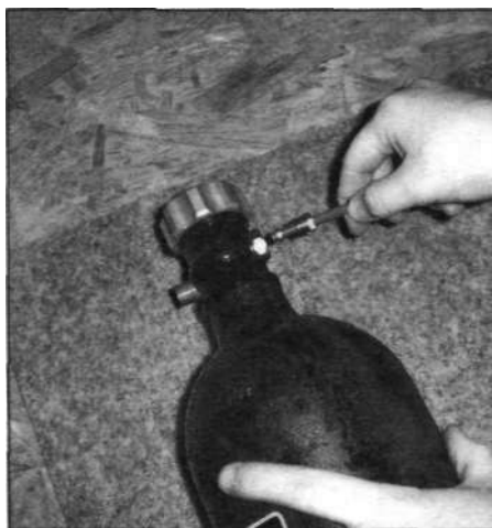
Заправляемый баллон располагается горизонтально рядом с большим баллоном (донором) и соединяется с ним специальной трубкой.
