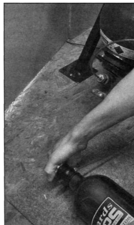
Заправляемый баллон наполняется полностью, после чего вентиль закрывается и заправочная трубка отключается.
