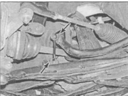
Рис. 26.9,в. Осмотрите втулки крепления [указаны стрелками] переднего и заднего стабилизаторов поперечной устойчивости на наличие износа и разрушений
