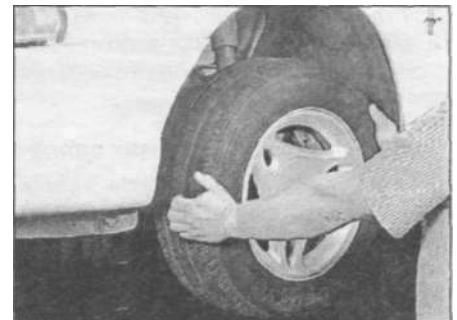
Рис. 26.11. Попробуйте развернуть колесо вправо - влево. Если при этом будет ощущаться люфт, проверьте крепления рулевого механизма, маятниковый рычаг и наконечники рулевых тяг
