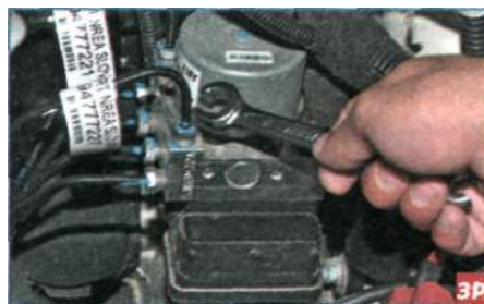
Специальным ключом «на 13» для штуцеров тормозных трубок отворачиваем штуцеры шести тормозных трубок...
