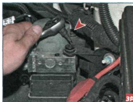
Шестигранником «на 5» отворачиваем два винта крепления блока ABS к кронштейну чашки левой амортизаторной стойки...
