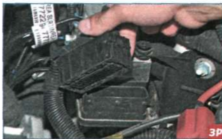
...и отсоединяем колодку жгута проводов от разъема блока.
