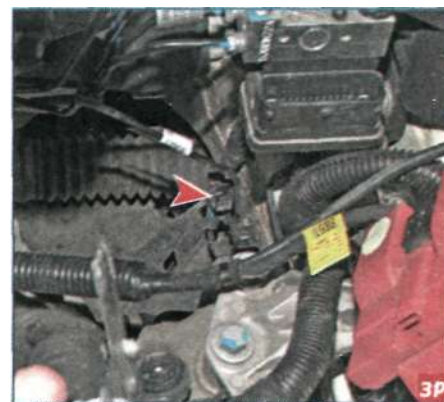
Крепление на левом лонжероне колодки жгута проводов моторного отсека и жгута проводов датчика скорости вращения колеса.
