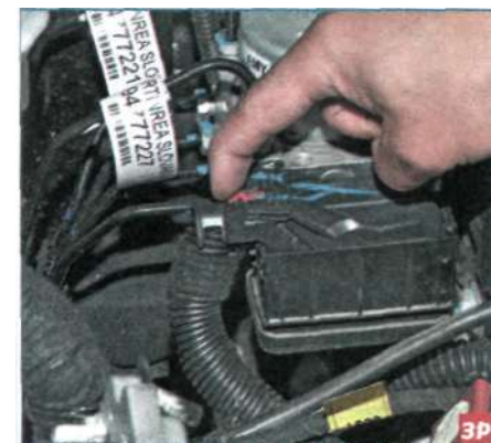
Сдвиг фиксатор скобы колодки жгута проводов...
