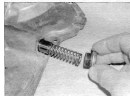
Рис. 12.5,а. Отверните крышку редукционного клапана
