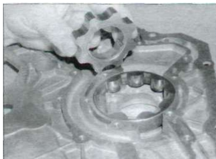
Рис. 12.4. Извлеките внутренний и наружный роторы
