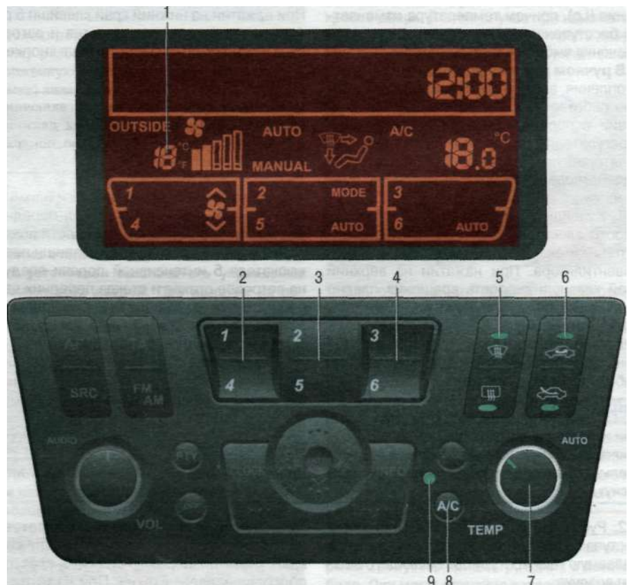
Рис. 1.11. Блок автоматического управления системой отопления (кондиционирования) и вентиляции салона: 1 - дисплей; 2 - переключатель режимов работы электровентилятора воздуханатетателя; 3 - переключатель распределения потоков воздуха/выключатель системы отопления и кондиционирования; 4 - выключатель автоматического режима работы кондиционера; 5 - выключатель интенсивной подачи воздуха на ветровое стекло и стекла передних дверей/выключатель электрообогрева заднего стекла; 6 - переключатель режима рециркуляции; 7 - регулятор температуры поступающего в салон воздуха; 8 - выключатель кондиционера; 9 - контрольная лампа включения кондиционера
