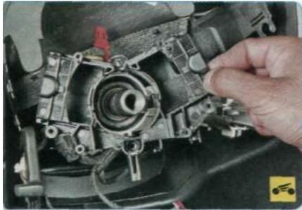
5. Отверните гайку крепления звукового сигнала...
