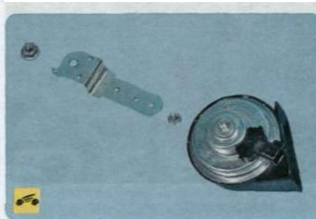
8. Установите новый звуковой сигнал в порядке, обратном снятию.
