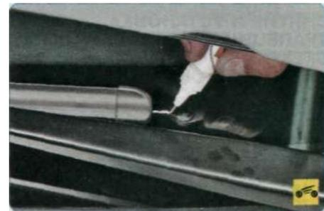
Для удобства установки промаркируйте перед снятием рычага положение щетки относительно стекла.
