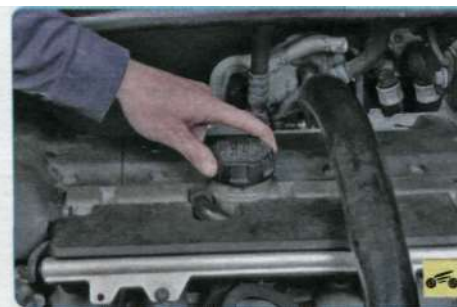
5. Для доливки масла выверните пробку маслоналивной горловины...
