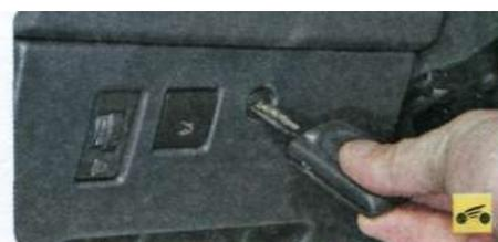
2. Поверните фиксатор крышки монтажного блока предохранителей...
