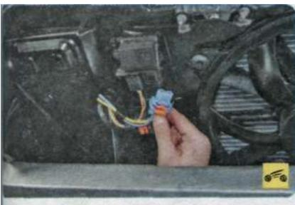
4. Отожмите фиксаторы и отсоедините [сопротивления колодки силового...
