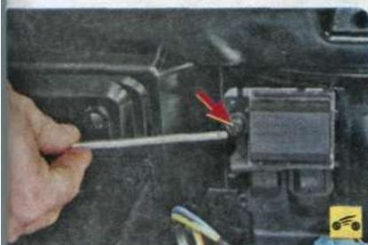
6. Выверните винт крепления дополнительного сопротивления...
