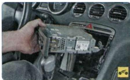
1. Извлеките головное устройство аудиосистемы из панели приборов (см. «Снятие и установка головного устройства аудиосистемы», с. 244).
