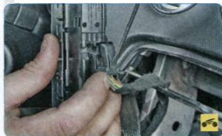
4. Сожмите держатель фиксатора колодки жгута проводов...
