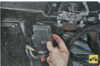
3. Отожмите фиксатор кожуха дополнительного сопротивления и снимите кожух.
