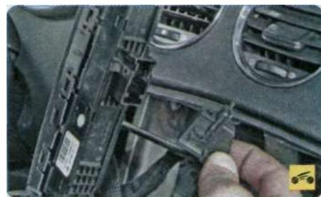
6. Отсоедините колодку жгута проводов от блока выключателей и снимите блок.
