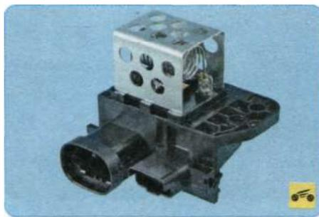
8. Установите дополнительное сопротивление электродвигателя вентилятора радиатора системы охлаждения в порядке, обратном снятию.
