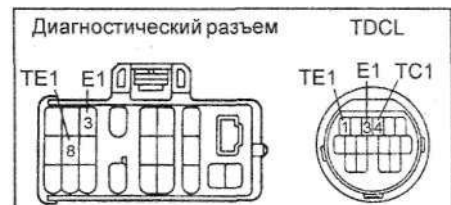
Диагностический разъем и разъем TDCL.
