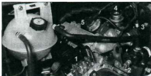
Рис. 4.1. Вид моторного отсека автомобиля Ford Transit: 1 — ТНВД ЕРІС фирмы Lucas; 2 — датчик температуры охлаждающей жидкости, 3 — датчик температуры воздуха на впуске; 4 — исполнительный механизм дроссельной заслонки системы рециркуляции ОТ; 5 — исполнительный механизм клапана системы рециркуляции ОТ
