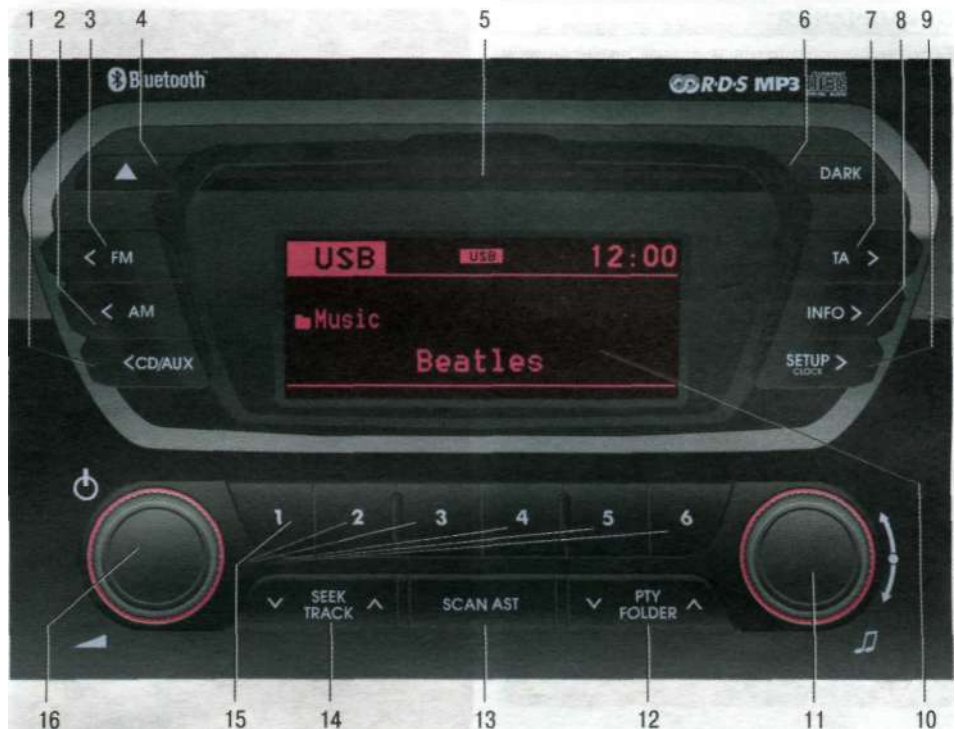
Рис. 1.11. Органы управления аудиосистемой: 1 - кнопка выбора режима воспроизведения компакт-диска и чтения с внешнего носителя «CD/AUX»; 2 - кнопка выбора диапазона средних волн «AM»; 3 - кнопка выбора диапазона ультракоротких волн «FM»; 4 - кнопка извлечения компакт-диска; 5 - слот для загрузки компакт-диска; 6 - кнопка регулировки яркости дисплея; 7 - клавиша выключения объявлений о ситуации на дороге (ТА); 8 - кнопка информационной строки «INFO» (в режиме проигрывания компакт-дисков/воспроизведения файта с внешнего носителя); 9 - кнопка вызова настроек аудиосистемы «SETUP»; 10 - дисплей; 11 - переключатель радиостанций (в режиме радио)/кнопка настройки тембра звучания, баланса системы; 12 - клавиша выбора активной папки (в режиме проигрывания компакт-дисков); 13 - клавиша сканирования радиочастот «SCAN» и автоматического сохранения с высоким уровнем приема «AST» (в режиме радио) воспроизведение композиций компакт-диска; 14 - клавиши поиска радиостанций (в режиме радио), переключения треков (в режиме проигрывания компакт-дисков); 15 - кнопки предварительной настройки радиостанций (в режиме радио) многофункциональные клавиши (в режиме проигрывания компакт-дисков); 16 - выключатель аудиосистемы, регулятор громкости
