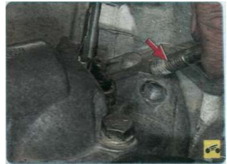
8. Выверните два болта крепления и снимите корпус термостата.
