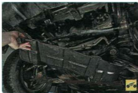
2. Снимите брызговик двигателя (см. «Снятие и установка брызговика двигателя и защиты силового агрегата», с. 65).
