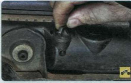
3. Слейте часть охлаждающей жидкости из системы охлаждения (см. «Замена охлаждающей жидкости», с. 92).
