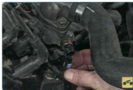
6. ...и датчика температуры охлаждающей жидкости системы управления двигателем.
