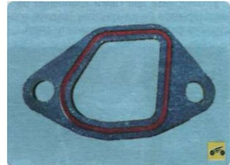
При каждом снятии корпуса термостата заменяйте прокладку новой.
