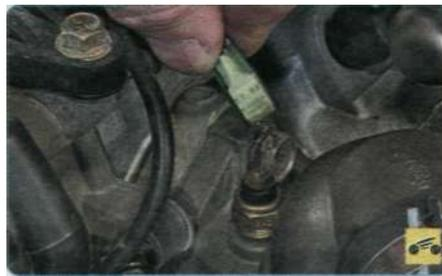
5. Отсоедините колодки жгутов проводов от датчика указателя температуры охлаждающей жидкости...
