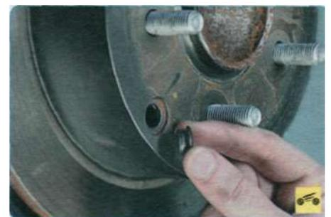
5. Выньте заглушки из отверстий для регулировки стояночного тормоза в дисках задних тормозов.
