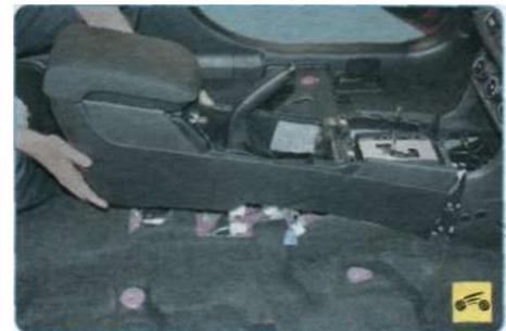
2. Если количество щелчков не укладывается в приведенный выше интервал, снимите облицовку тоннеля пола (см. «Снятие и установка облицовки тоннеля пола», с. 248)...
