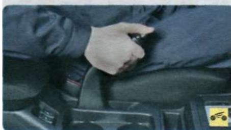
1. Поднимите рычаг стояночного тормоза вверх до упора, при этом вы должны услышать 3-5 щелчков храпового устройства.
