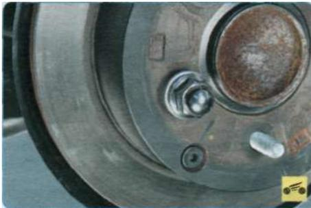
**Для предотвращения падения диска навинтите гайку на одну из шпилек крепления колеса.**
