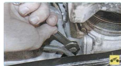
9. С правой передней стороны двигателя выверните болт крепления кронштейна дополнительного оборудования к масляному картеру.
