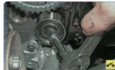
8. ...со стороны моторного отсека выверните болт его крепления...
