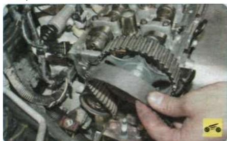
...снимите ремень с зубчатого шкива коленчатого вала, с натяжного и промежуточного роликов и шкива распределительного вала...
