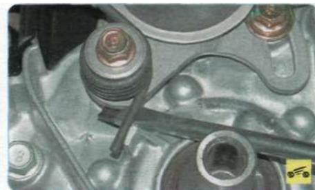
2. Выведите концы пружины натяжного ролика из приливов корпуса масляного насоса, подцепив их отверткой (для наглядности показано со снятым зубчатым шкивом коленчатого вала).
