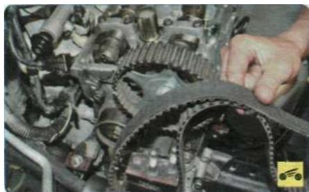
...и извлеките ремень из моторного отсека.
