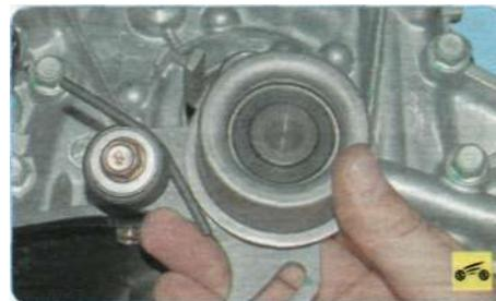
4. ...и снимите натяжной ролик вместе с пружиной.
