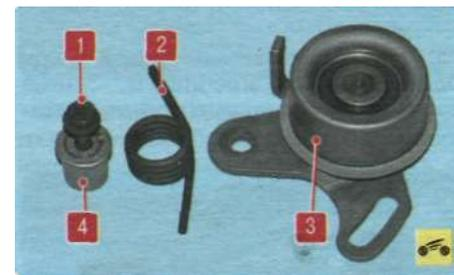
Так выглядят детали натяжного ролика: 1 - болт; 2 - пружина; 3 - натяжной ролик с кронштейном; 4 - втулка.
