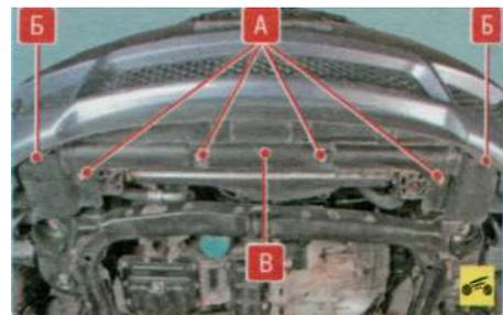
Для снятия нижней облицовки В переднего бампера выверните четыре болта А ее креп-
