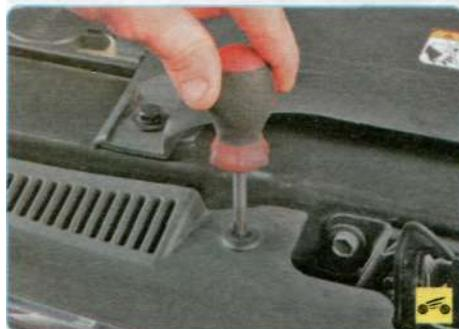
2. Выверните фиксатор пистона верхнего крепления бампера к рамке радиатора...
