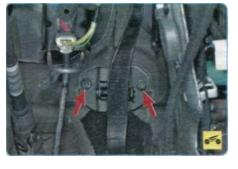
4. Отверните гайки крепления кронштейна педали к щиту передка и снимите педаль.
