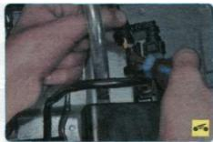
3. Отсоедините от клапана продувки адсорбера колодку жгута проводов...
