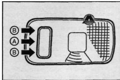
Если переключатель находится в положении ON (A), освещение включится при открывании подъемной задней двери кузова. При закрывании подъемной задней двери кузова, освещение выключится. Если переключатель находится в положении OFF, освещение выключится.
