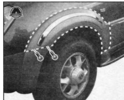
8. Отвернуть задний болт петли крышки капота, а также верхние болты крепления крыла. Снять крыло.
