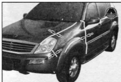
2. Снять облицовку переднего бампера (1), фару (2) и боковой повторитель указателя поворота (3).
