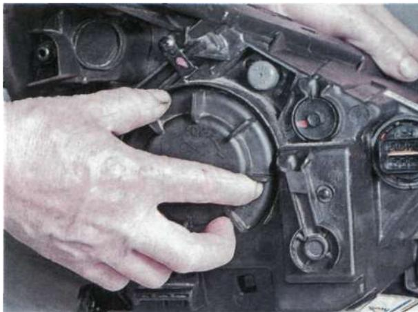
...и снимаем крышку.
