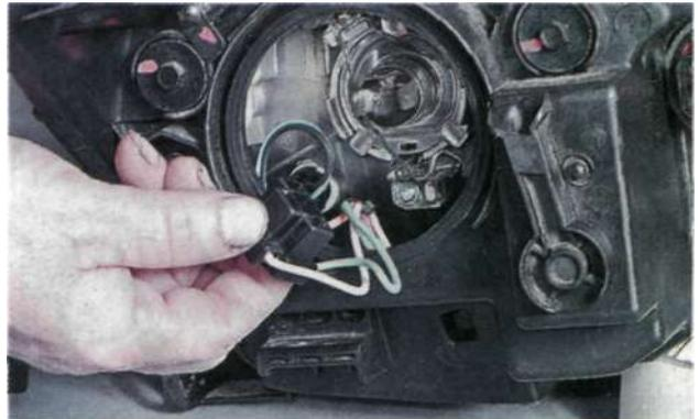
4. Нажимаем скобу пружинного фиксатора и поворачиваем его в верх.
