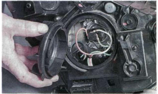
3. Для замены лампы дальнего/ближнего света, отсоединяем от нее колодку жгута проводов.
