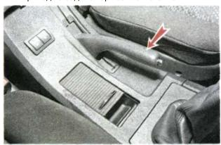
Для включения стояночного тормоза необходимо потянуть рычаг вверх до упора (6-8 щелчков). При включенном зажигании на щитке приборов загорается контрольная лампа включения стояночного тормоза (с. 17, «Щиток приборов»).
