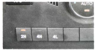
Для включения требуемого режима необходимо нажать соответствующую кнопку. В момент работы сервопривода на щитке приборов мигает контрольная лампа **4WD** (с. 17, «Щиток приборов»).
