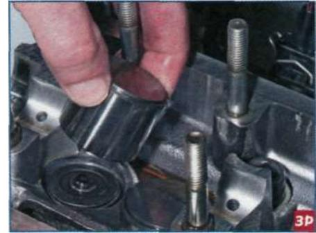
Вынимаем толкатель с регулировочной шайбой из гнезда головки блока цилиндров.
