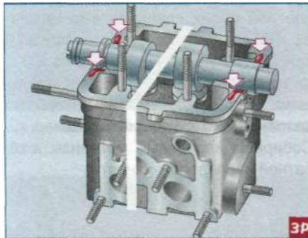
На поверхности головки блока цилиндров, сопрягающиеся с корпусами подшипников распределительного вала в зоне крайних опор, наносим тонкий слой герметика.
