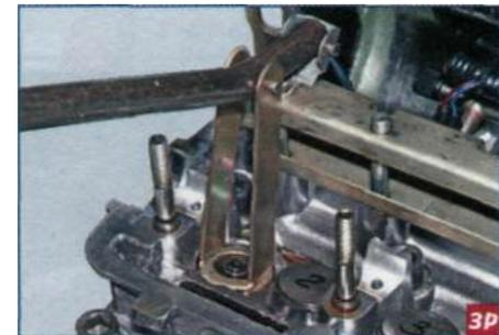
Подпятник рассухаривателя упираем в тарелку клапана, а зацепной рычаг заводим в паз, расположенный на задней стороне планки.
