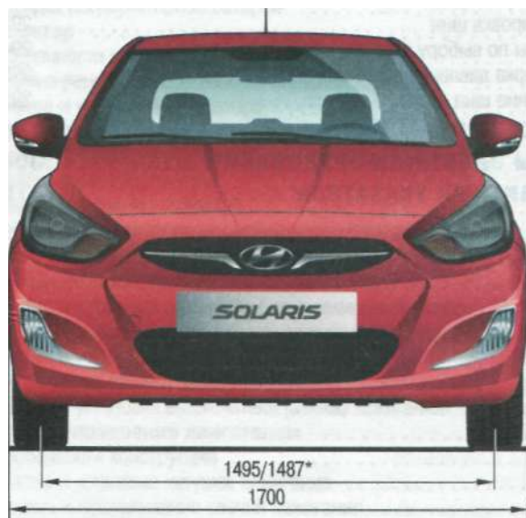
Рис. 1.1. Габаритные размеры автомобиля с кузовом седан
