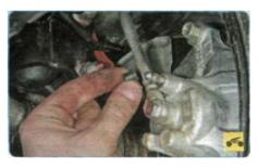
3. Очистите от грязи клапаны выпуска воздуха и снимите защитные колпачки клапанов рабочих цилиндров тормозных механизмов передних...
