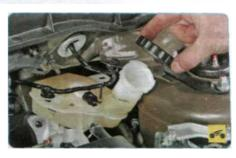
1. Отверните пробку бачка главного тормозного цилиндра.
