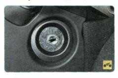
19 - выключатель (замок) зажигания, объединенный с противоугонным устройством, расположен с правой стороны рулевой колонки. Ключ в замке может занимать одно из четырех положений:
