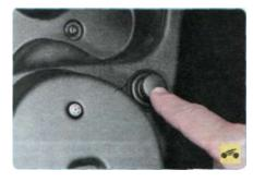
14 - прикуриватель. Для пользования прикуривателем нажмите на кнопку его подвижной части (ключ в замке зажигания в положении «А» или «М»).
