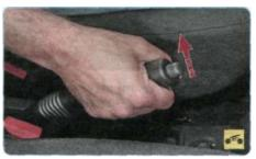
Для того чтобы затормозить автомобиль стояночным ^рмозом, поднимите рычаг до упора вверх - в блоке сигнализаторов загорится красным светом сигнализатор 9 (см. рис. 1.9).
