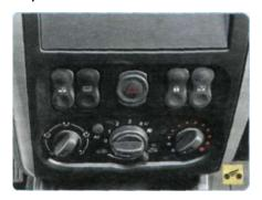
13 - блок управления системой отопления (кондиционирования) и вентиляции салона, см. «Отопление (кондиционирование) и вентиляция салона», с. 19.
