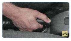
...опустите рычаг до упора вниз - сигнализатор должен погаснуть.
