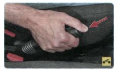
Для того чтобы растормозить автомобиль, потяните рычаг немного вверх и, нажав на кнопку в торце рукоятки рычага...
