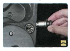
После нагрева спирали в течение 10-20 с кнопка подвижной части автоматически со щелчком вернется в исходное положение и прикуриватель можно извлечь для использования.
