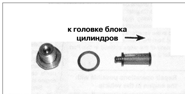
Рис. 4.8. Если Вы подозреваете, что возникла проблема с системой VVT, проверьте фильтр OCV, не засорился ли он; при установке нового фильтра используйте новое уплотнительное кольцо и убедитесь в том, что больший край фильтра направлен в сторону головки:
