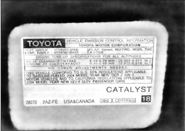
Рис. 1.6а. На табличке с информацией о системах снижения токсичности отработавших газов (VECI) содержится такая важная информация, как тип системы снижения токсичности отработавших газов, установленной на двигателе, и некоторые спецификации по регулировке
