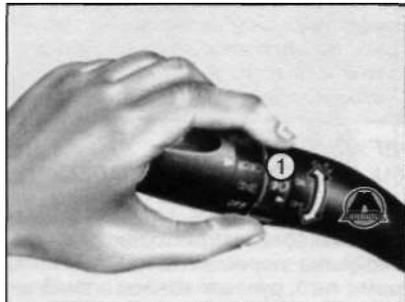
Противотуманные фары используются для улучшения видимости и предотвращения аварий в условиях плохой видимости, - например, в условиях тумана, дождя, снегопада и т.д. Для включения противотуманных фар переведите переключатель противотуманных фар (1) в положение ВКЛ (ON) после включения стояночных огней.
