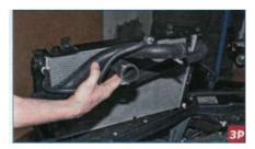
...и вынимаем его в сборе со шлангами из моторного отсека.
