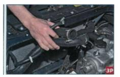
Поэтому отсоединяем подводящий и отводящий шланги радиатора от патрубков корпуса термостата и подводящий трубы насоса, соответственно, а пароотводящий шланг радиатора отсоединяем от штуцера расширительного бачка.
