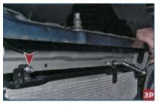
Головкой «на 10» отворачиваем две гайки крепления радиатора к верхней поперечине рамки радиатора.
