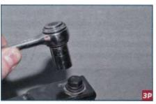
...головкой «на 12» отворачиваем два болта крепления планки радиатора к его бачкам.
