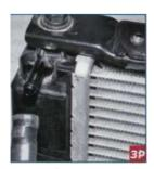
...а от штуцера левого бачка - пароотводящий шланг (при снятии шланга со штуцера будьте осторожны - не обломите штуцер).
