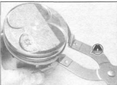
15.5. Снятие поршневых колец при помощи специального инструмента.
