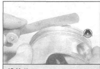
15.11. Измерьте зазор между поршневым кольцом и канавкой при помощи плоского шупа.
